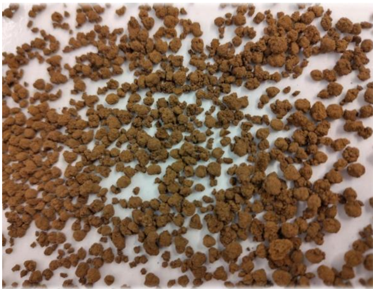
Figuur 1: Close-up van de oranje-bruine fosfor adsorberende filtratiekorrels
